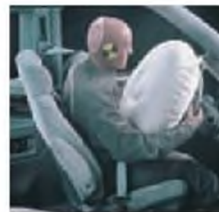
▲ Figura 3.6 Una bolsa de aire para automóvil. La descomposición de azida de sodio, \text{NaN}_3(s) , se utiliza para inflar las bolsas de aire de los automóviles. Cuando se enciende adecuadamente, la \text{NaN}_3 se descompone con rapidez y forma nitrógeno gaseoso, \text{N}_2(g) , el cual expande la bolsa de aire.
